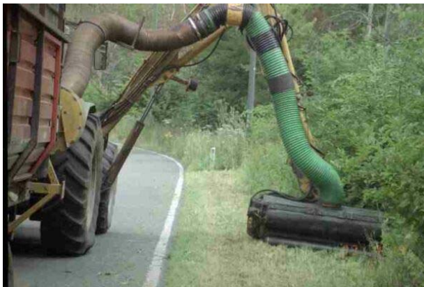
Foto 6. 4 Cirkelmaaier met opzuiginstallatie
